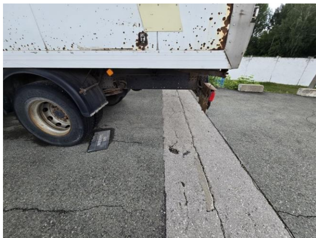
Фото 6. MAN.TGM-18.280-4X2-BB: задняя боковая нижняя часть, колесная зона, крепления и видимые следы коррозии.
