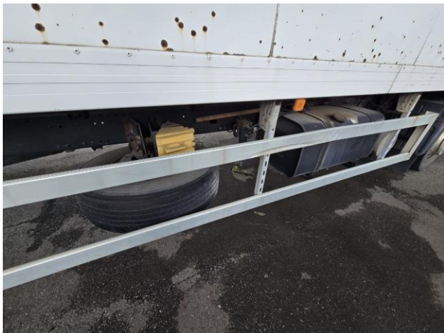
Фото 3. MAN.TGM-18.280-4X2-BB: передняя часть кузова-фургона, следы коррозии и повреждения по кромке.
