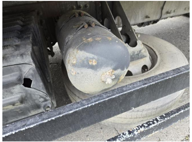
Фото 34. VOLVO FM-TRUCK 6X2: воздушный ресивер и элементы ходовой части.
