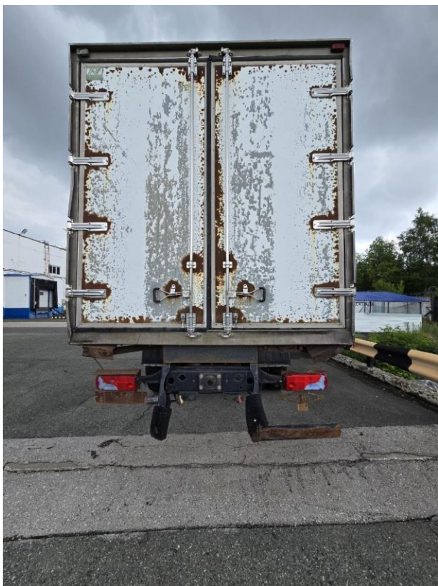
Фото 5. MAN.TGM-18.280-4X2-BB: задняя часть кузова-фургона, двери, петли, светотехника и запорные элементы.
