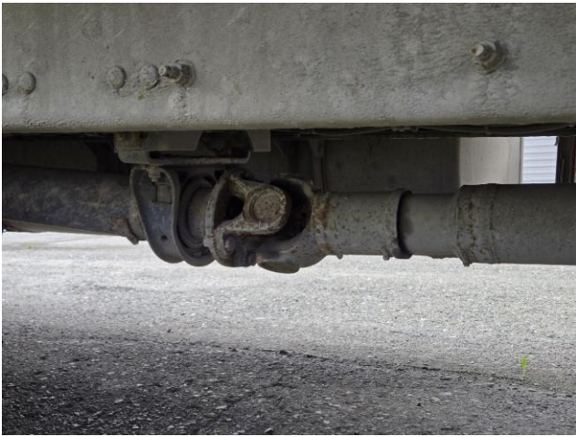
Фото 33. VOLVO FM-TRUCK 6X2: нижняя часть рамы и карданный вал.
