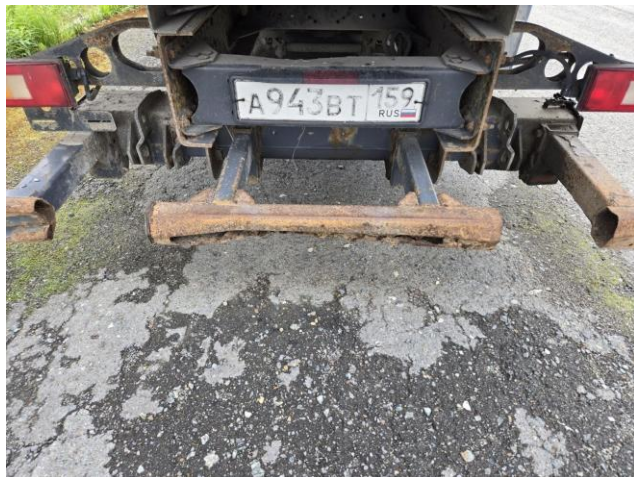
Фото 30. VOLVO FM-TRUCK 6X2: задняя нижняя часть, рама, задний противоподкатный брус и государственный регистрационный знак.
