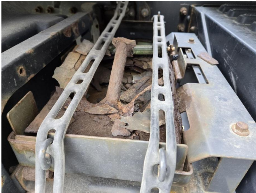
Фото 35. VOLVO FM-TRUCK 6X2: зона за кабиной, элементы рамы, крепления и следы коррозии.
