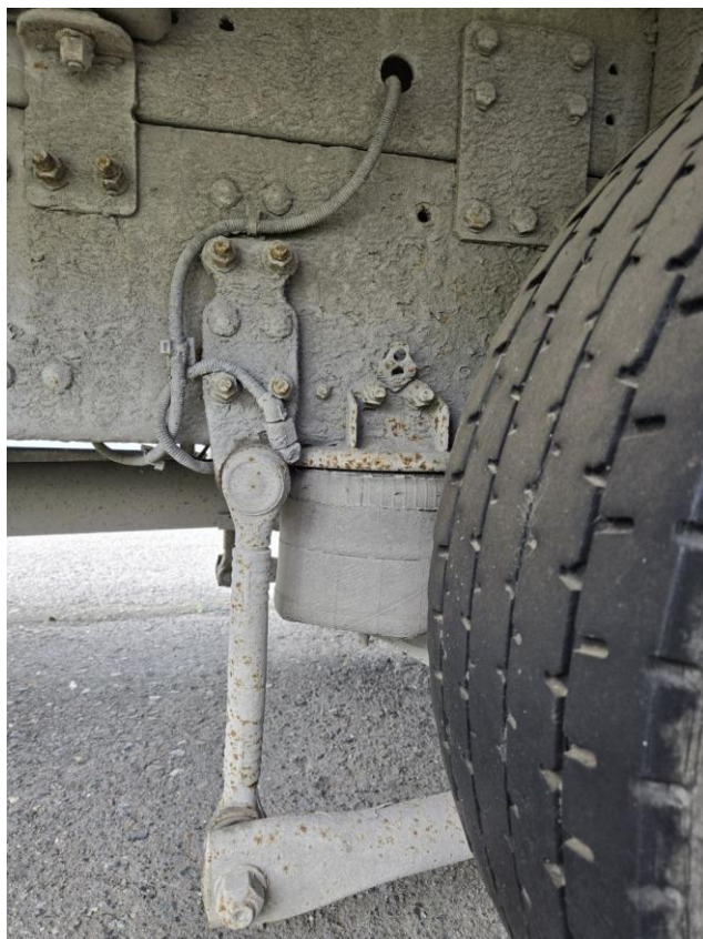
Фото 32. VOLVO FM-TRUCK 6X2: элементы подвески и крепления в задней колесной зоне.
