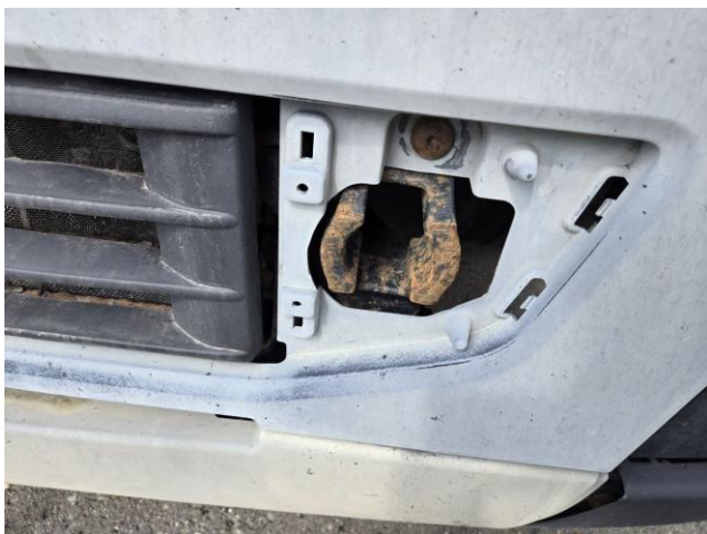
Фото 27. VOLVO FM-TRUCK 6X2: передняя часть кабины, отсутствующий элемент облицовки и видимые металлические детали.
