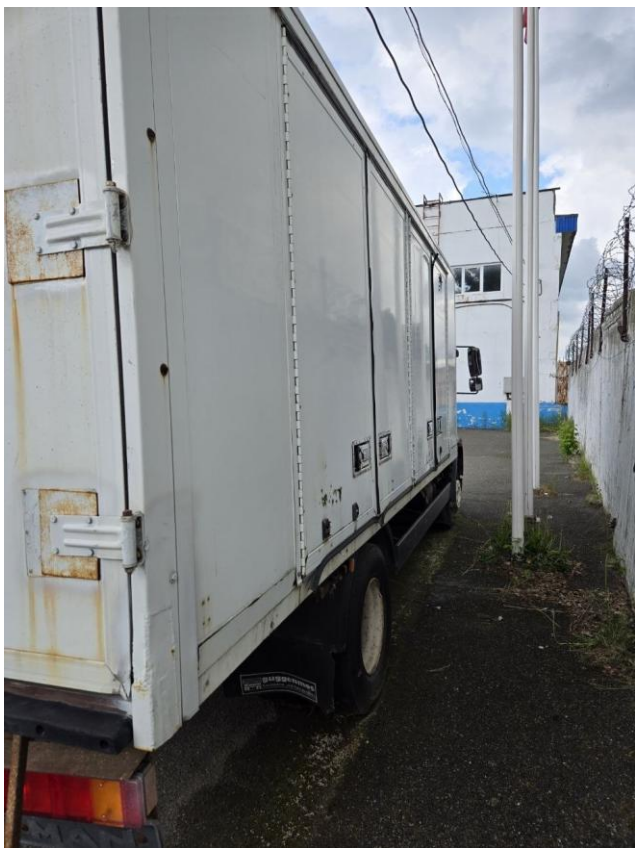
Фото 17. MAN-LE15.220: боковая часть кузова, локальные повреждения, следы коррозии, состояние замков и панелей.
