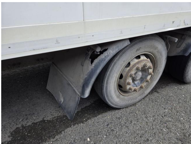
Фото 31. VOLVO FM-TRUCK 6X2: задняя колесная зона и повреждение крыла.
