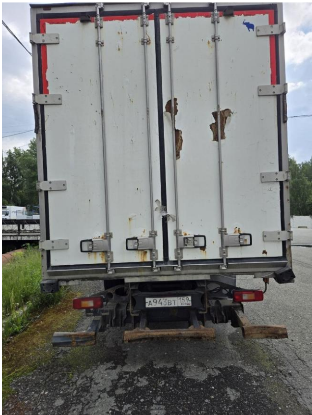
Фото 29. VOLVO FM-TRUCK 6X2: задняя часть кузова-фургона, двери, петли, запорные элементы и светотехника.
