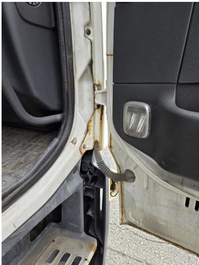
Фото 11. MAN-LE15.220: дверной проем кабины, следы коррозии по петлям и кромкам дверного проема.
