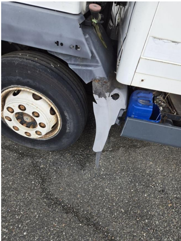
Фото 15. MAN-LE15.220: передняя часть кузова и крыла, следы эксплуатации, повреждения и коррозия.
