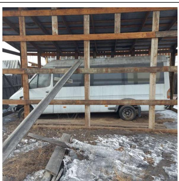
**Техническое состояние транспортного средства:** не на ходу, двигатель отсутствует, часть сидений отсутствуют, салон в ржавчине, бамперы отсутствуют, шины колес спущены из-за потрескавшейся резины.
