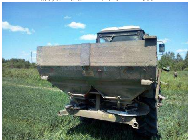
Разбрасыватель Amazone ZA-M 900
