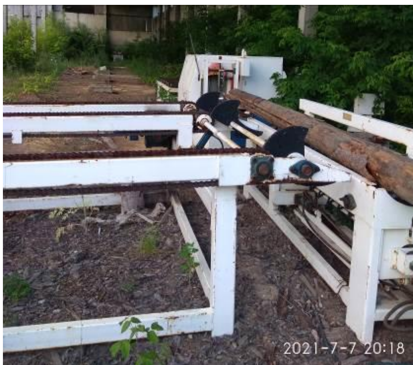
Стол механизации для подачи бревен в многопильный станок (б\у) (инв. № 23)
