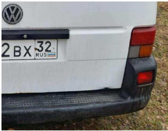
Повреждения двери задка
