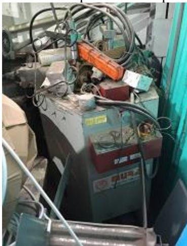
Гидравлический пресс для соединения угла HP-112, инв. № 3778
